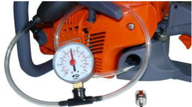
**c) Control válvula respiradero tanque carburante**
