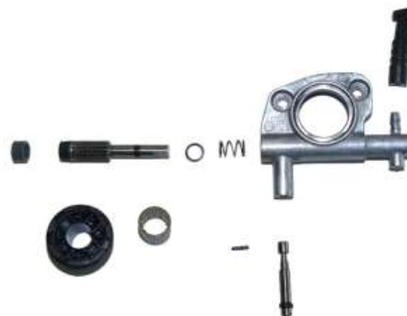
**Importante:** se si encuentran dificultada de rotación del engranaje de la bomba de aceite es necesario el desmontaje de las partes y la limpieza con gasolina.
