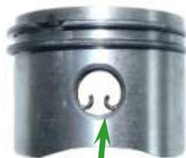
**Atención:** durante la fase de montaje posicionar el seeger con la apertura hacia la parte inferior del pistón
